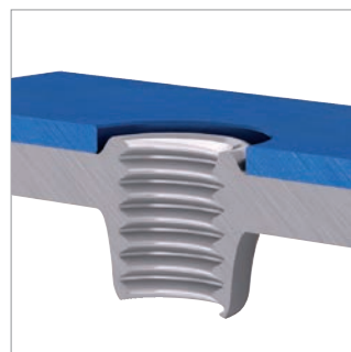
Gefurchtes Gewinde im Blechdurchzug Formed thread in sheet metal rim
